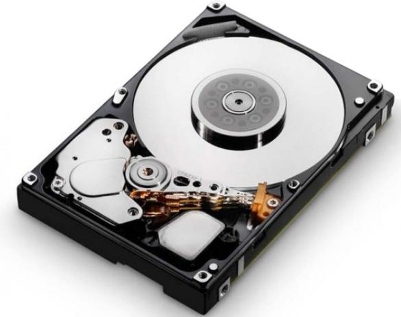
Aquí vemos un disco duro magnético abierto, en el que podemos apreciar los discos que almacenan los datos y los brazos con los cabezales lectores.
